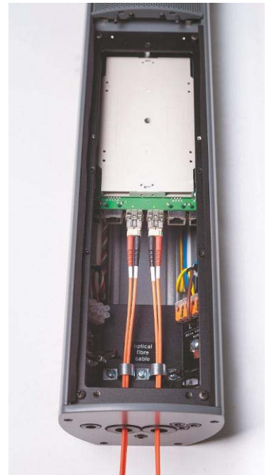
Aktuelle Modelle der Linea Focus Serie verfügen über eine Optocore-Schnittstelle
