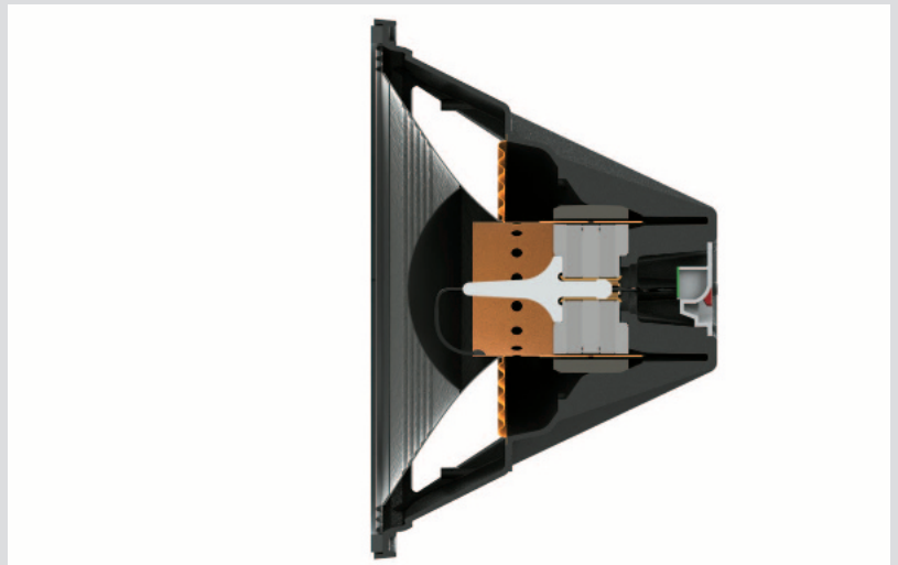
2264H Tieftöner ebenfalls mit Differential-Drive-Antrieb und Neodym-Magneten – man beachte die Kabelführung durch den Polkern
