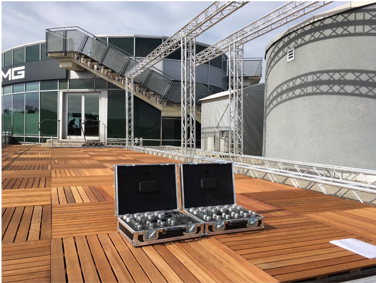
Abbildung 2: Zwei Starter-Kits um vorhandene Truss-Systeme auf die Schnellverbindingssysteme nachzurüsten
