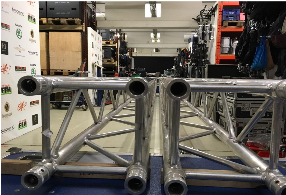
Abbildung 5: Vergleich einer 10m Konusstrecke (links) gegenüber einer 10m RESBIG „two“ Verbindungsstrecke
