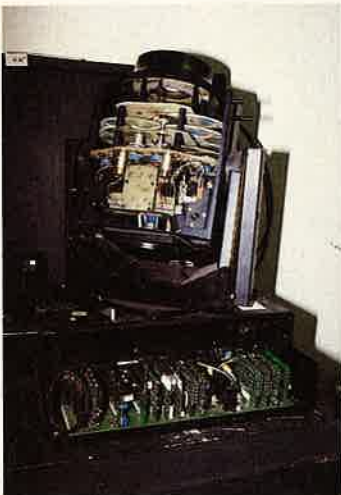
◀ Ein Starlite von innen. Gut zu erkennen die Farb- und Goloräder.
